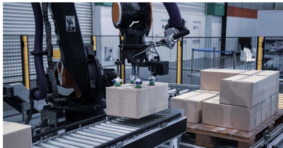
ピッキングロボット
